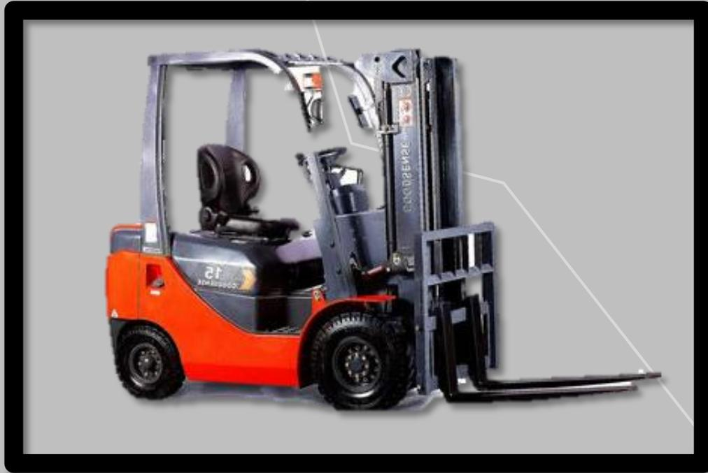
Equipos con capacidad de carga de 1.000 hasta 3.000 kilogramos, especiales para sótanos o lugares con poco espacio
